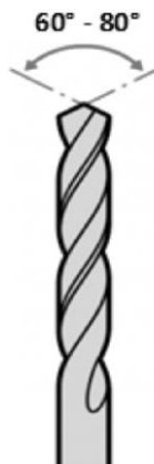
Rys.3 Zalecany kąt wiertła
