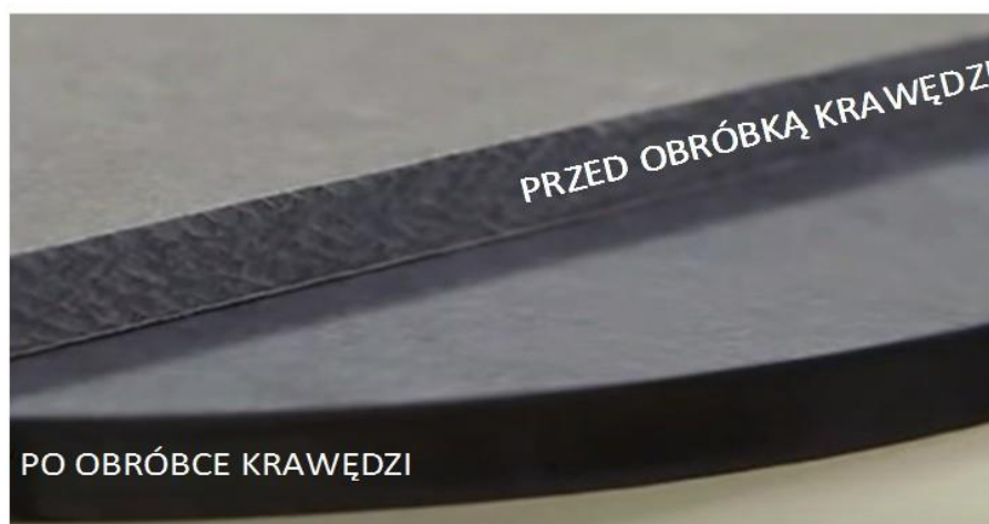
Rys.10 krawędzie przed i po polerowaniu
