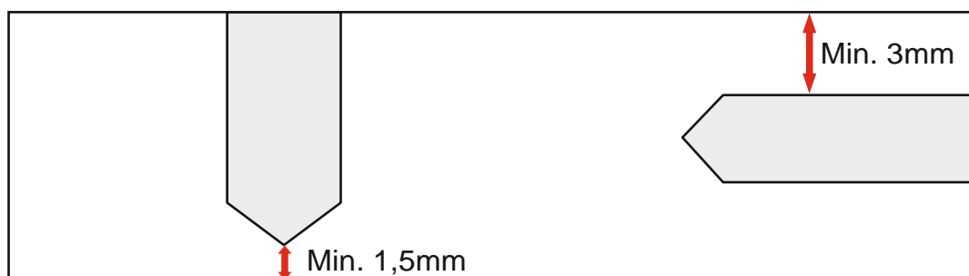
Rys.2 Odległość otworów od krawędzi
